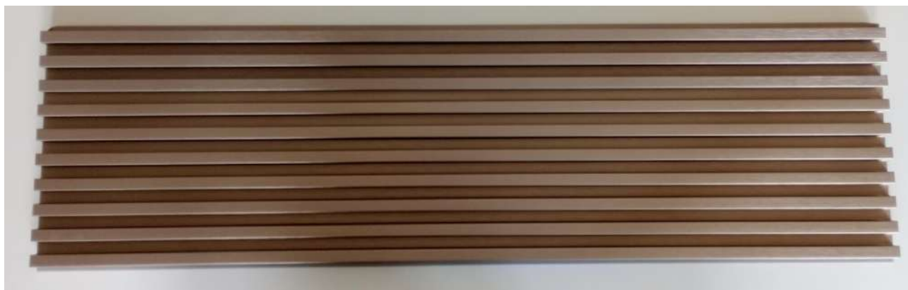
Rys. 1. Próbką panelu lamelowego S przygotowana do badania.
