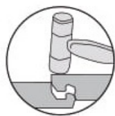
Położenie paneli: dobrze
