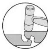
Położenie paneli: źle
